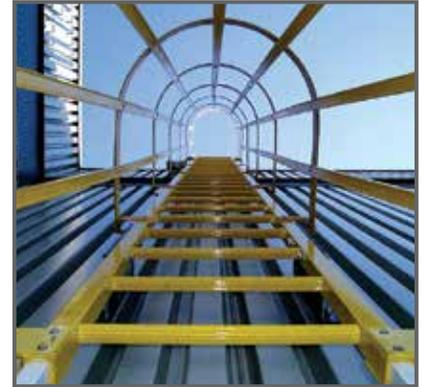
Les dispositifs de sécurité sont intégrés dès le départ. Des cornières de fixation spéciales ont été développées pour ancrer solidement l'échelle. Des étriers de dégagement intermédiaires offrent une stabilisation latérale de l'échelle aux espaces de 6' de la structure porteuse. Les barreaux d'échelle fortement dentelés offrent des prises de pied antidérapantes.
